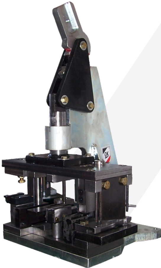
70902 Punzonadora manual OK (M-45CC) Ventana Corrediza Patagonia 45° x unidad
