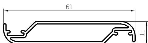
Tablilla Giratoria 0,457 kg/m 00414 Barras de 6,05m 10 Barras por Paquete
